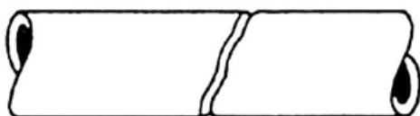
Skada p.g.a. rörbrott
